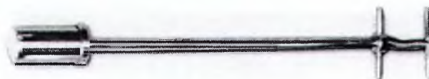
Hình 2. Tuýp lấy mẫu chế phẩm lỏng và chế phẩm bột ngoài da
